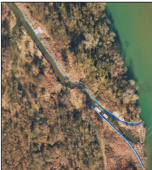
Figure 7 : Emprise de l'ouverture en rive droite pour l'opération de terrassement de la banquette en rive droite. En bleu foncé, le fond de la lône ; en bleu clair, la ligne d'eau au débit réservé ; en pointillés le terrassement de la banquette.
