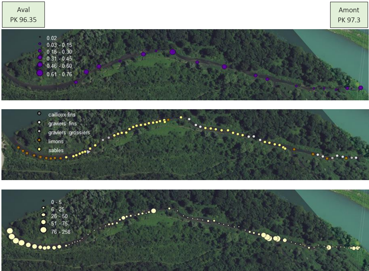
Figure 27 : Vitesse d'écoulement au débit réservé (en m/s) ; nature du substrat dominant ; épaisseur de sédiments fins (en cm). Source : Levés hydromorphologiques sur la lône des Cerisiers, GéoPeka, 2020.
