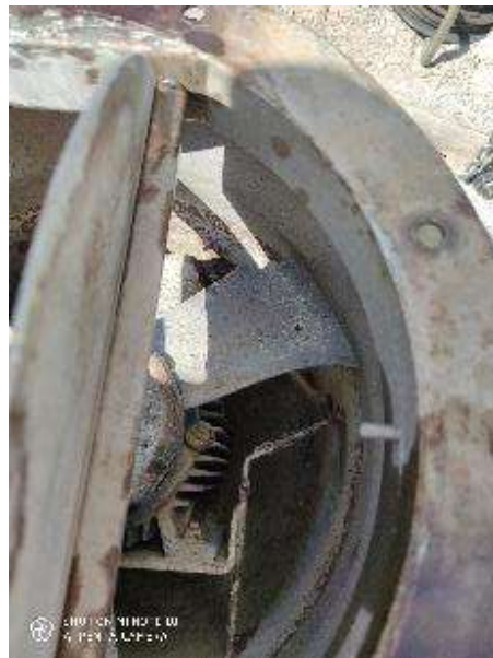
Hélice du ventilateur abîmé
