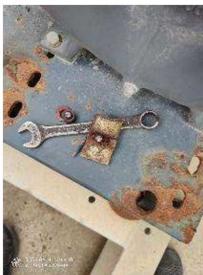
Fixation du moteur du surpresseur cassée
