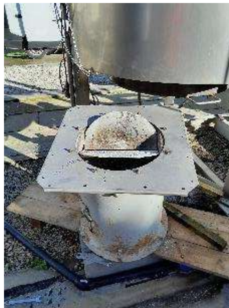
Plaque de fixation du brûleur sur le ventilateur
