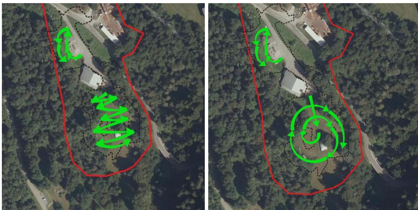
Plan de décapage à moindre impact (Zig zag depuis la salle polyvalente à gauche, centrifuge à droite)
