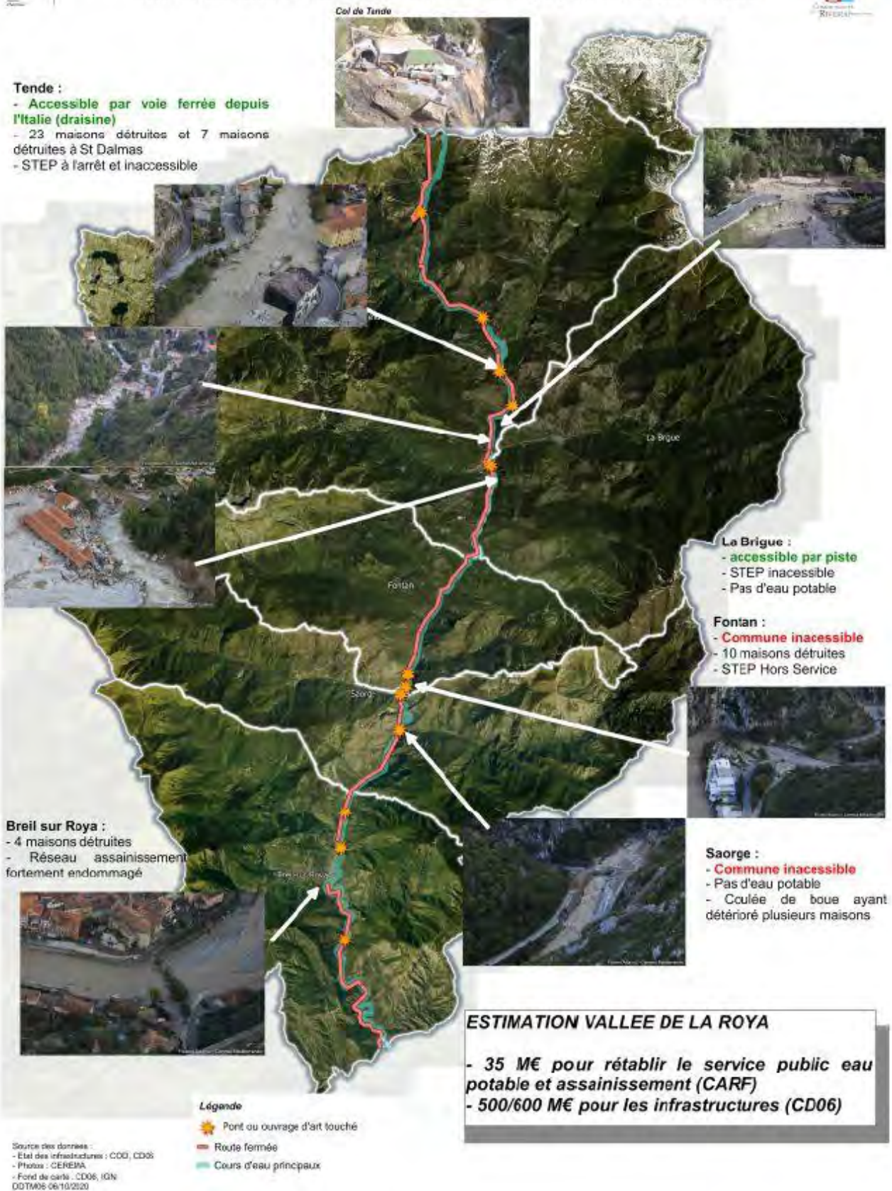
Principaux dégâts suites aux crues du 02 octobre 2020 dans la vallée de la Roya (carte extraite du rapport Retour d'expérience des intempéries des 02 et 03 octobre 2020 dans les Alpes-Maritimes du CGEDD d'octobre 2021)
