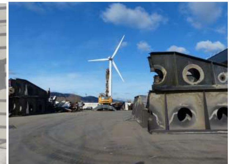
Plateforme SOLUWASTE : pièces très volumineuses à chalumer (cliché IATE 01/23)
