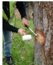
A noter : l'échantillonnage d'arbre n'endommage pas l'arbre et il laisse 3 trous de l'ordre de 5mm de diamètre et de 10 mm de long dans le tronc, qui pourront être rebouchés de résine naturelle ou d'une pâte
