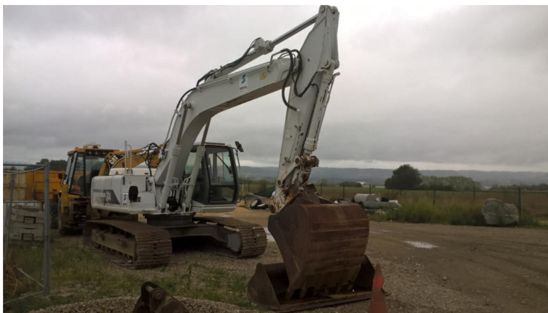
Engin de terrassement pour travaux d'aménagement : Pelle à chenille 20T JCB
