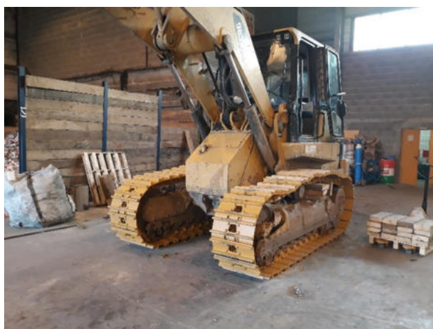
Engin de recouvrement : chargeuse à chenille CATERPILLAR 963D
