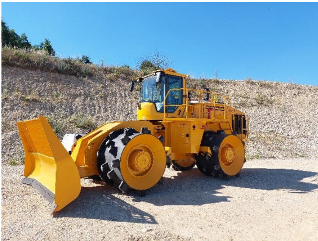
Engin de compactage : compacteur VANDEL 450 de 45T
