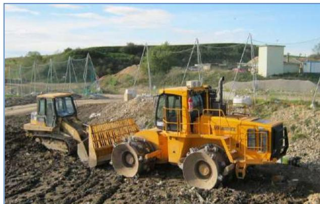
*Engins de recouvrement et de compactage :
