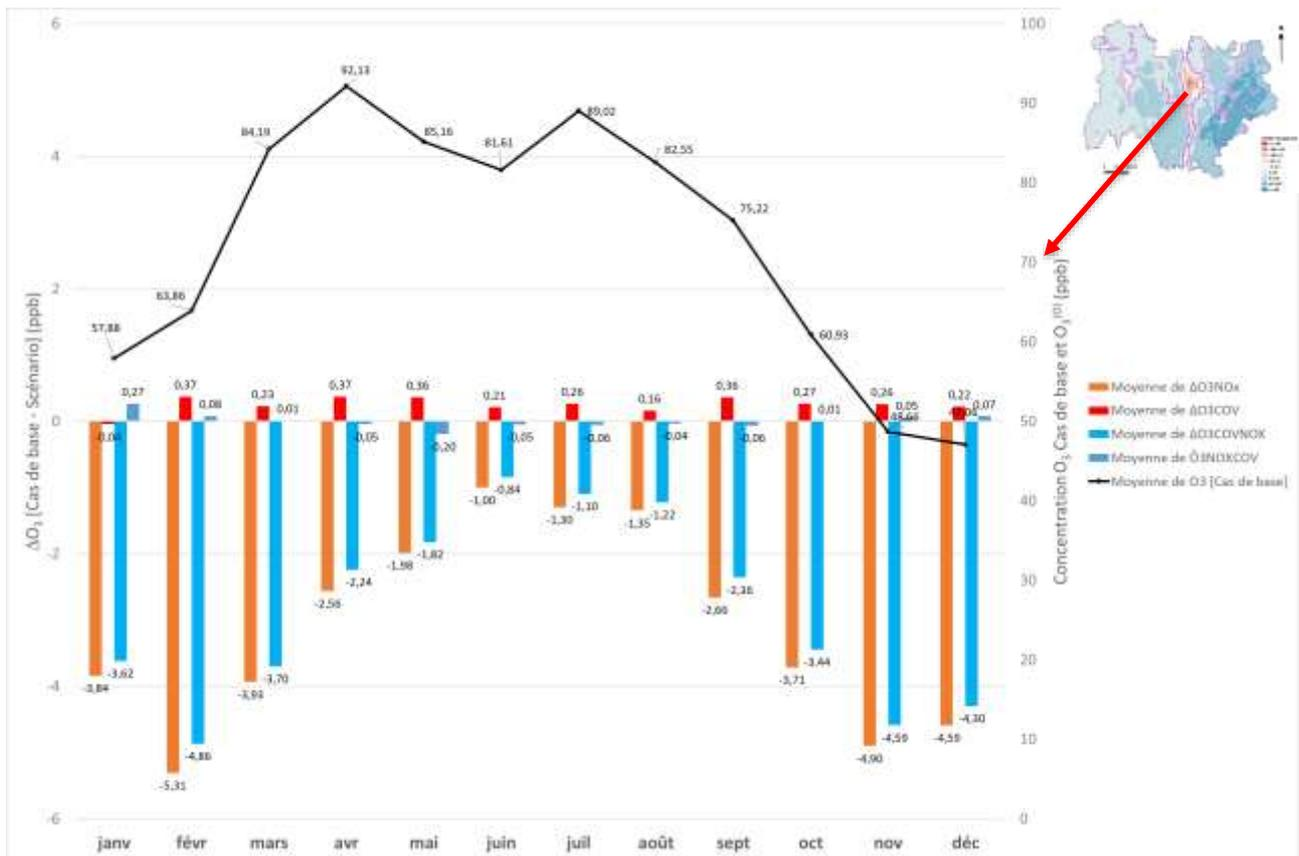
Figure 38 - Impact des réductions d'émissions à 35 % des NOx sur la zone interne. L'impact est calculé en fonction des écarts avec le cas de base [Cas de base -scénario]. La courbe noire représente la concentration moyenne du domaine modélisée. Toutes les valeurs sont exprimées en ppb.
