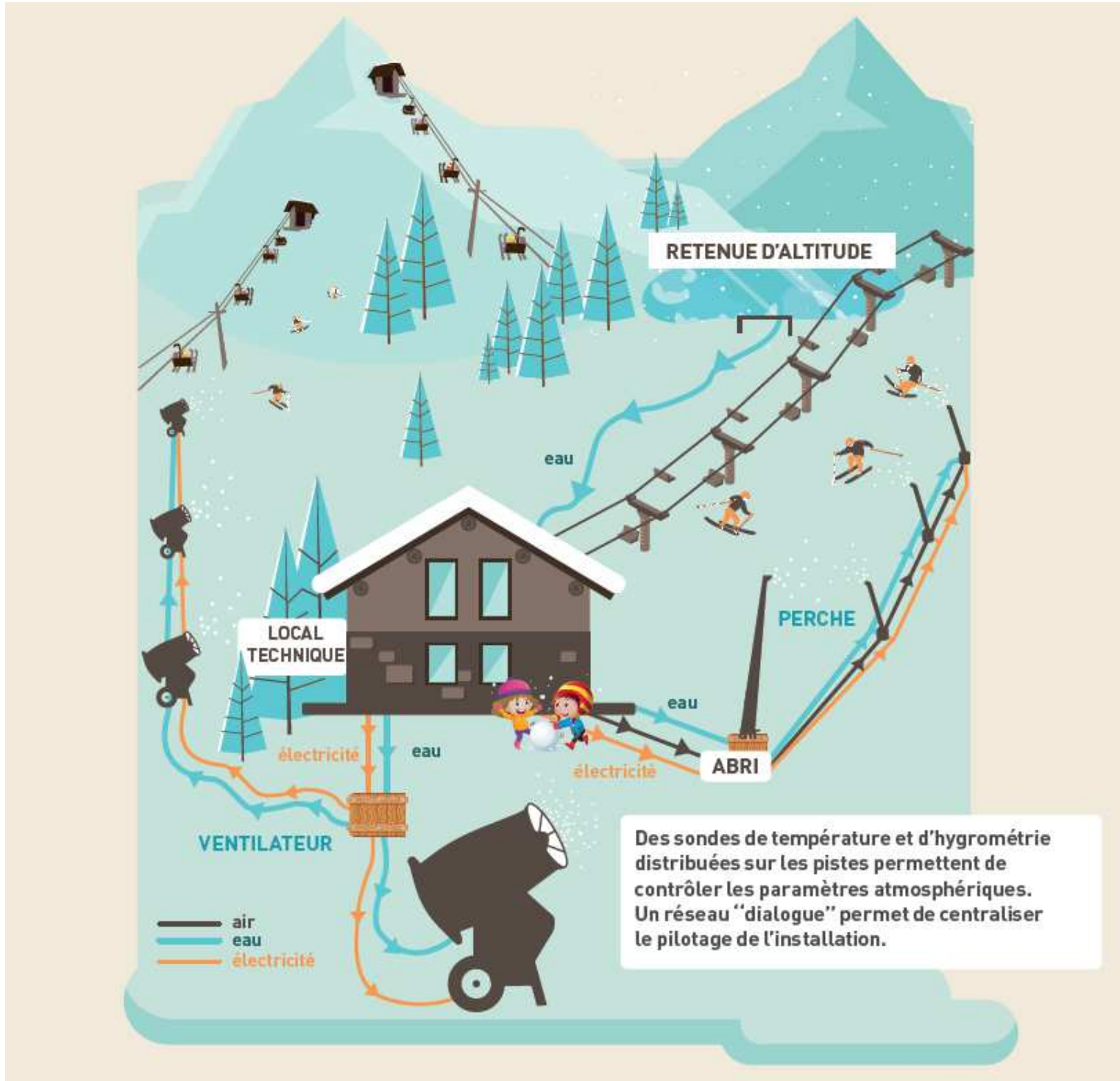
Figure 1: Schéma de principe d'une installation de production de neige de culture
