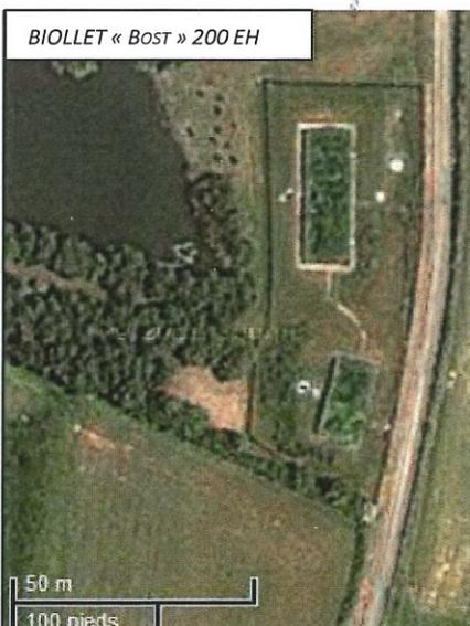
Un dénivelé de **4 mètres minimum** est nécessaire entre l'Entrée et la Sortie de la station d'épuration.
