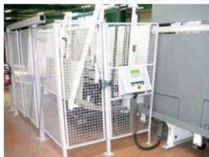
Robot de dépose automatique d'intercalaire
