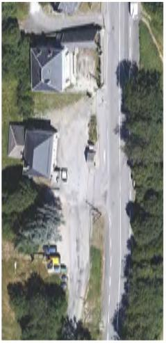
Grâce aux îlots bordurés, le tourne à gauche est sécurisé d'une part pour les véhicules venant de la route du col (RD113b) et s'insérant sur la RN85 et d'autre part pour ceux venant de la RN85 et voulant emprunter la route du col (RD113b).
