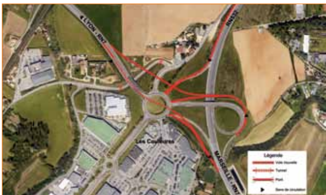
Variante de dénivellation de la solution 2 : par passage inférieur
