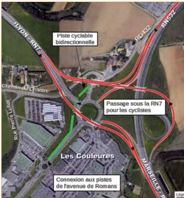
Proposition de création d'une piste cyclable en périphérie du carrefour, passant sous la RN7, connectée à la RD432 et aux pistes de l'avenue de Romans.
