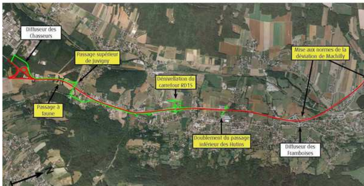
RD 1206 - Mise à 2x2 voies Chasseurs - Machilly
