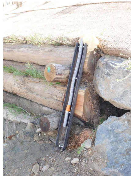
Sondes de pression fixes dans les bassins écrêteurs
