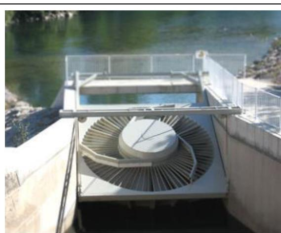
Figure 6 : Exemple de machine VLH installée
