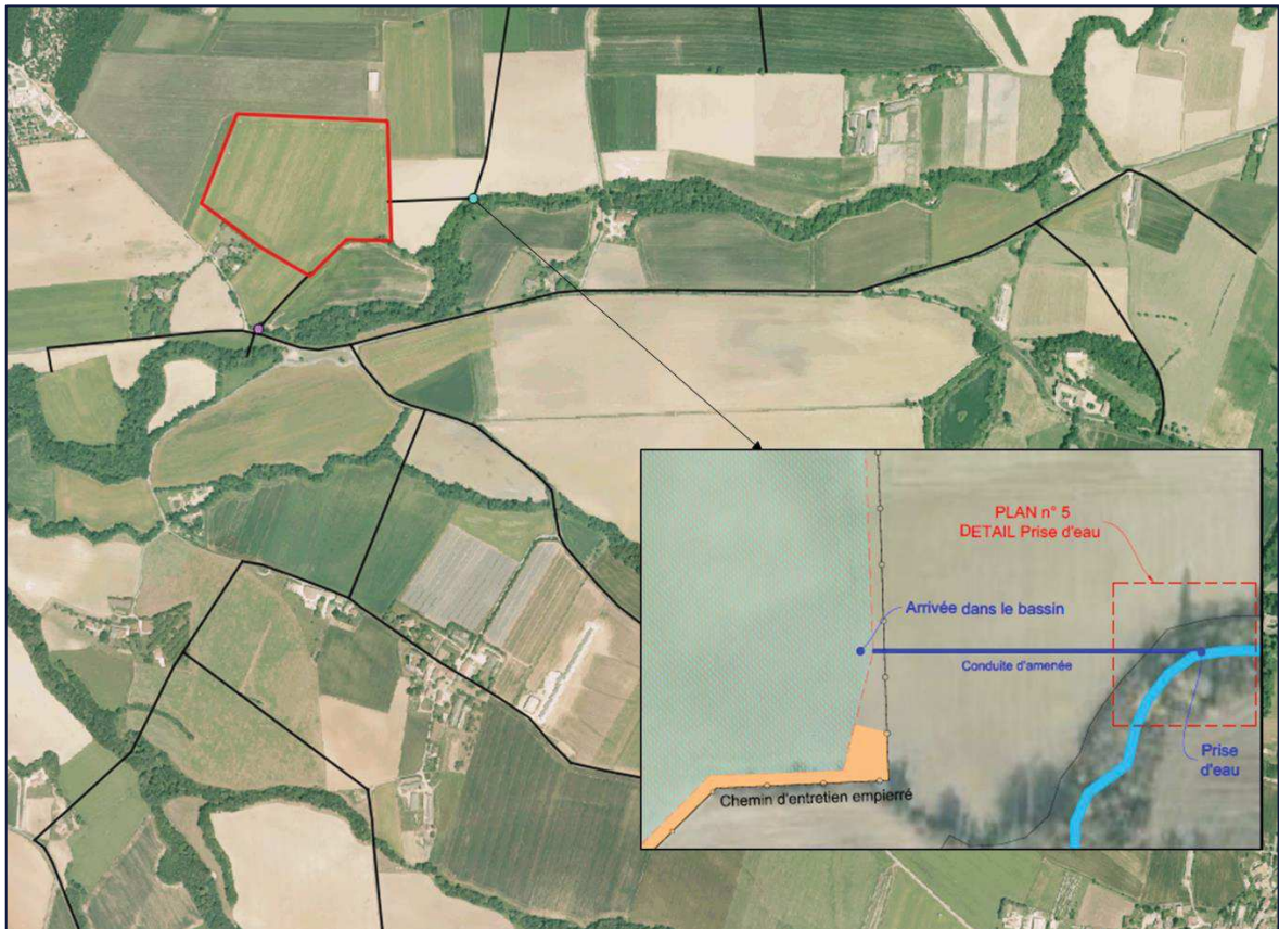
Figure 3: Localisation de la prise d'eau dans la Lierne réalisée pour l'alimentation de la retenue
