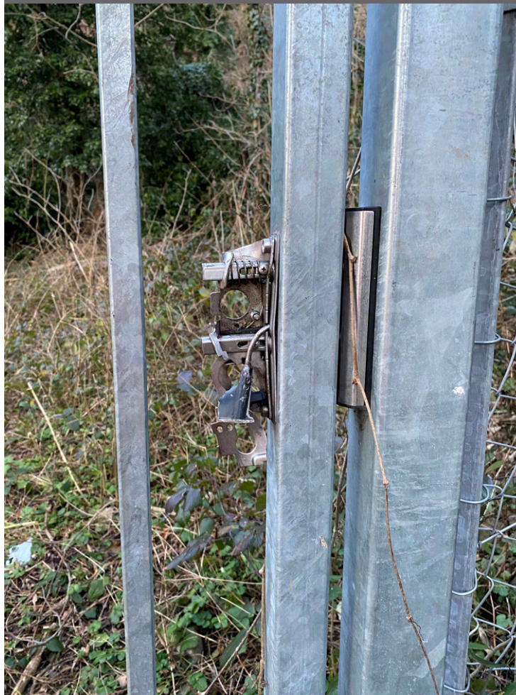
Serrure fracturée – Couriot B
