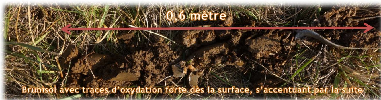
Figure 5. Détail d'un sondage de classe III (S1)
