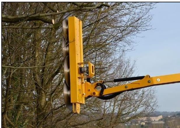
**Exemple de lamier scie à disques en fonctionnement**
