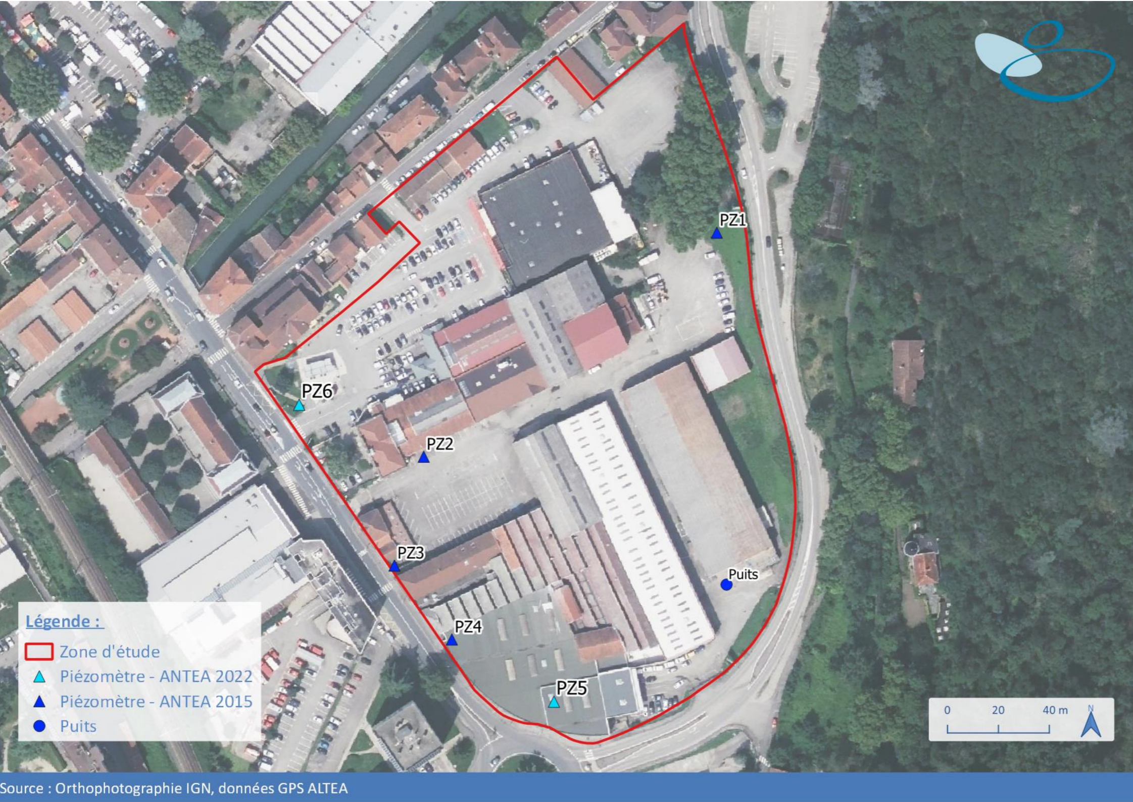
Figure 13 : Carte d'implantation de l'ensemble des piézomètres réalisé entre 2015 et 2022 par ANTEA (Source : MO)
