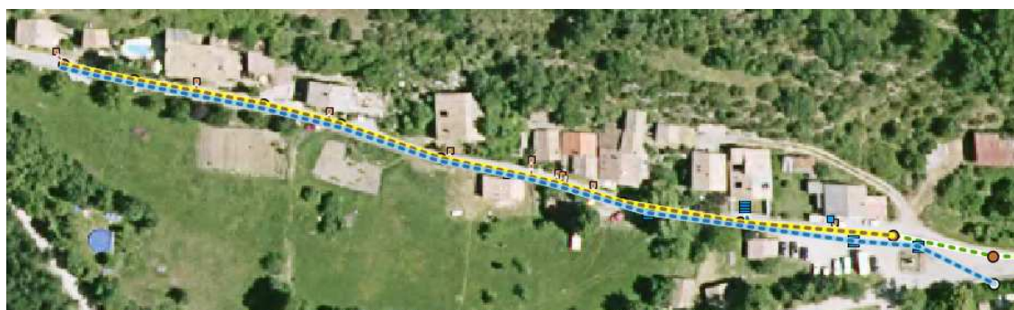
LOCALISATION DES RESEAUX A CREER (Réseau EU en jaune et réseau EP en bleu) Source : SIG Réseaux – Fond BD ORTHO IGN mis à disposition conventionnée
