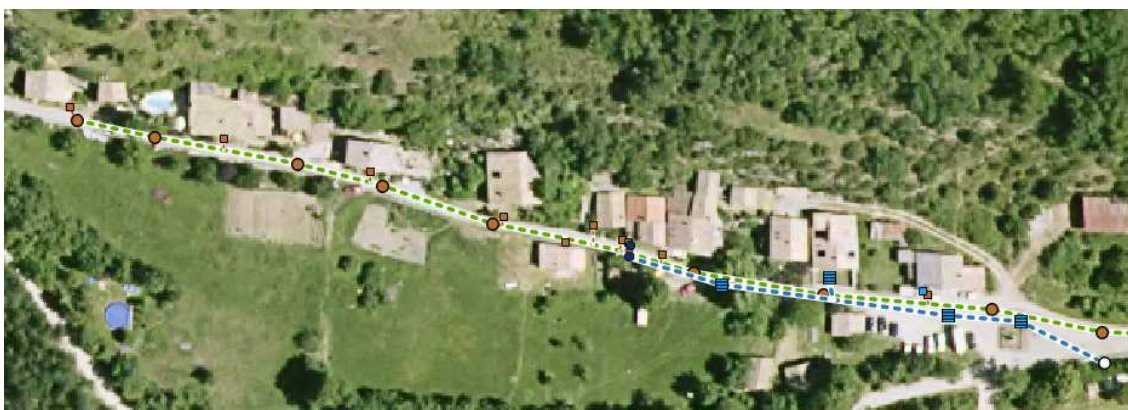
SITUATION ACTUELLE – Réseau unitaire de petit diamètre (Béton 150) Source : SIG Réseaux – Fond BD ORTHO IGN mis à disposition conventionnée
