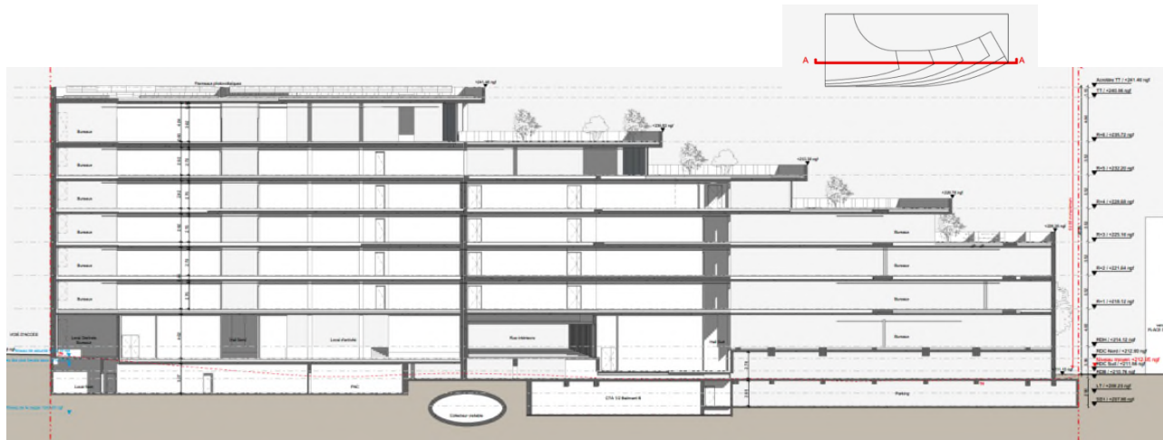
Figure 21 – Coupe AA avec indication des principales cotes du bâtiment
