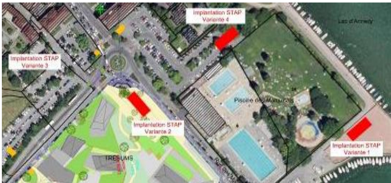
Figure 5. Variantes d'implantation de la station de pompage
