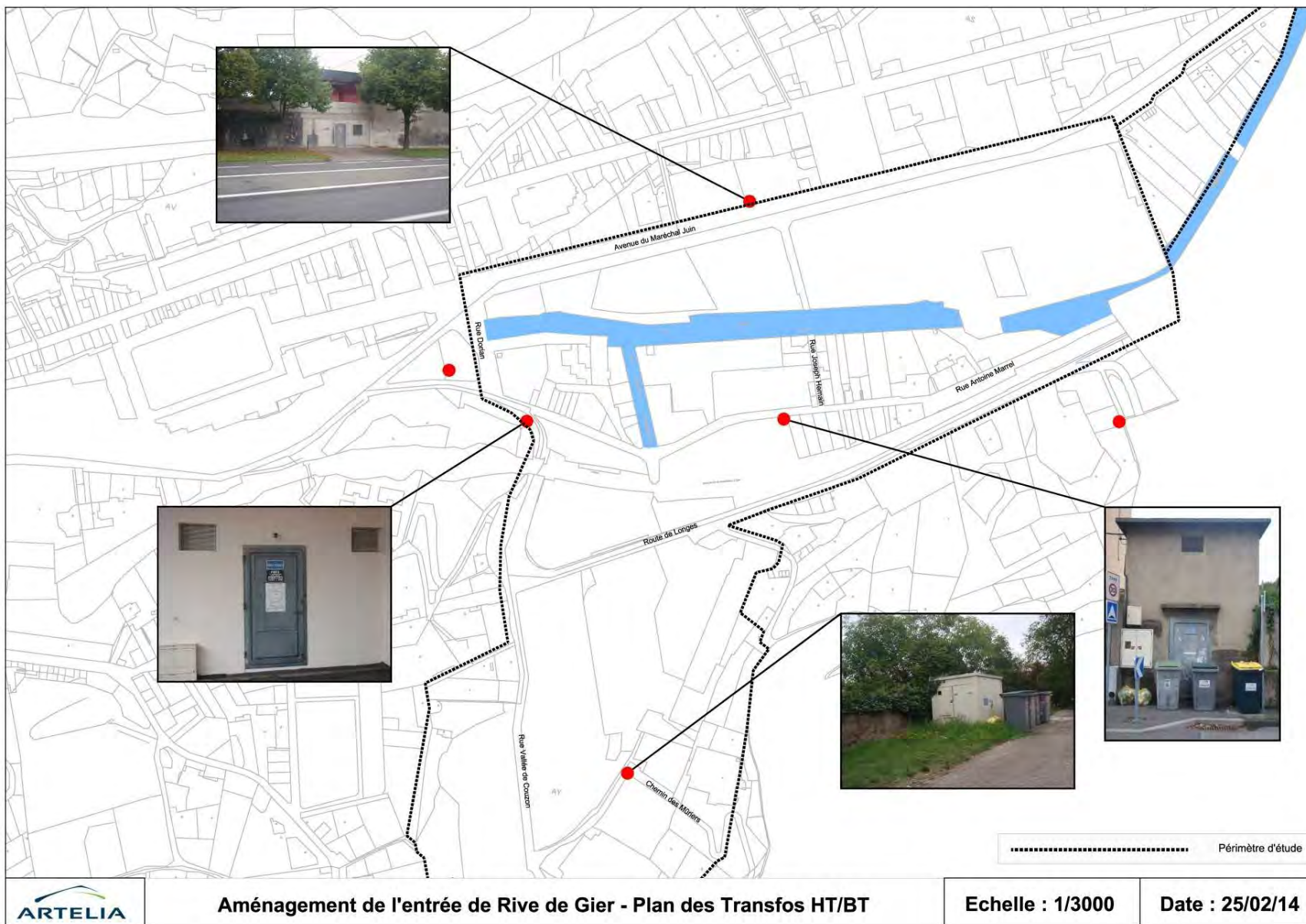
Figure 94 : Plan des transformateurs HT/BT
