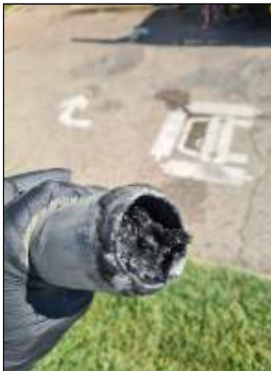
Traces de pollution à 3 mètres de profondeur au droit de S12
