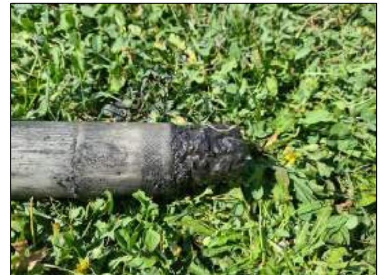
Traces de pollution à 5 mètres de profondeur au droit de S12
