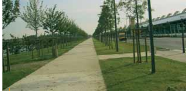
Cheminement en béton poreux
