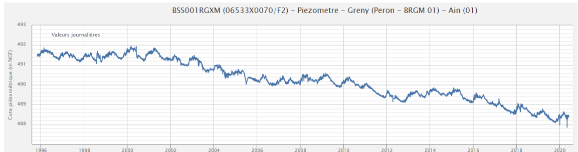
Figure 7 : Chronique piézométrique au droit de l'ouvrage BSS001RGXM (source : ADES.Eaufrance)
