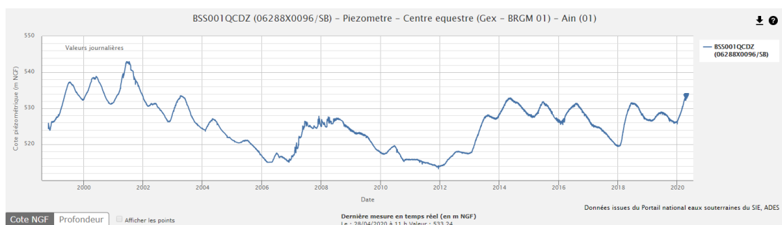
Figure 6 : Chronique piézométrique issue de l'ouvrage BSS001QCDZ (source : ADES.Eaufrance)
