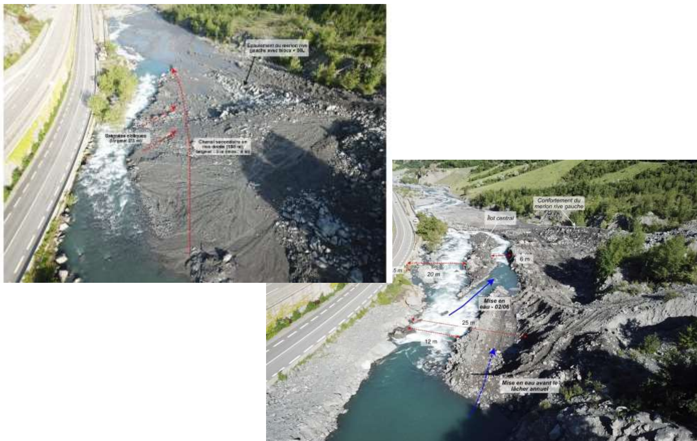
Figure 11 : Vue sur la confluence du Poucet avant et après travaux de scarification et création d'un chenal réalisés en 2020
