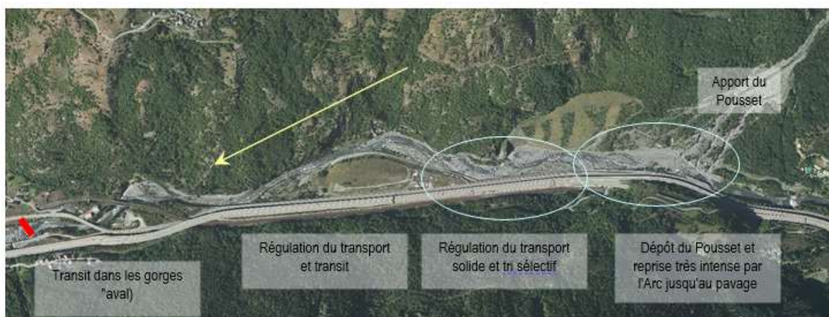
Figure 14 : Fonctionnement du transport solide dans le secteur amont lors des crues
