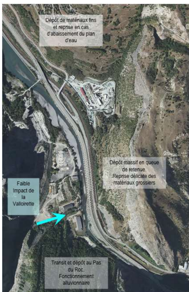
Figure 15 : Fonctionnement du transport solide lors des crues dans le secteur aval
