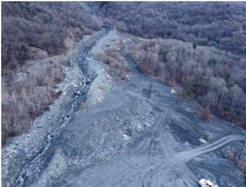
Figure 8 : Plate-forme de stockage temporaire créée sur le cône lors du curage de la confluence en 2024
