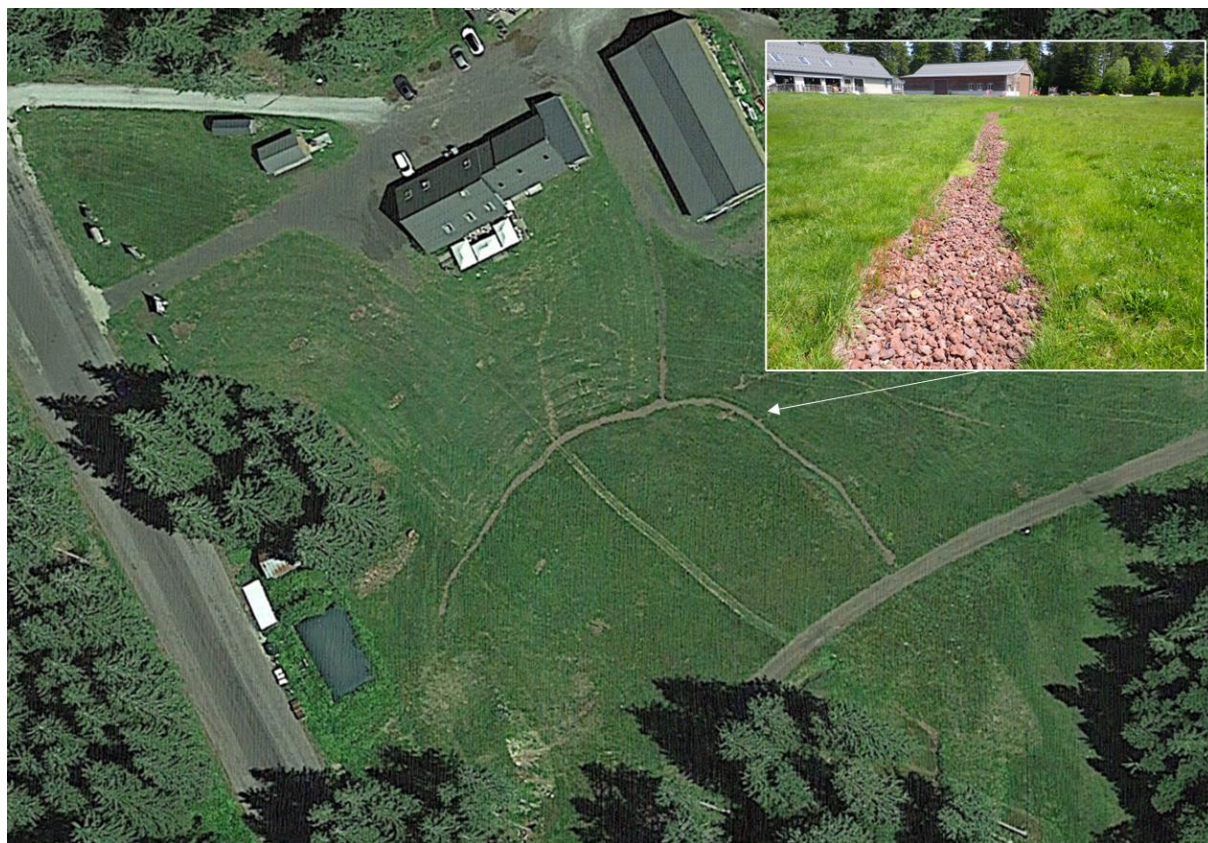
Figure 4. Drains dans la prairie humide
