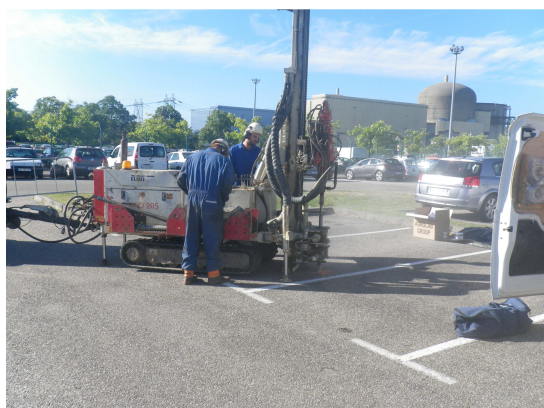
Réalisation d'un forage grâce à une machine sur chenille équipée d'un carottier battu
