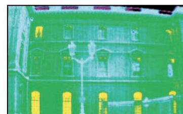
ABSENCE DE PONTS THERMIQUES - THERMOGRAPHIE DU LOUVRE (SOURCE APUR)
