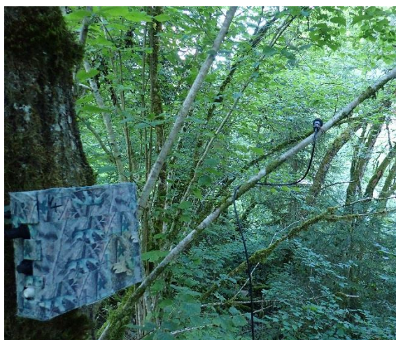
Photo 1 : enregistreur automatique SM2 (sur site)
