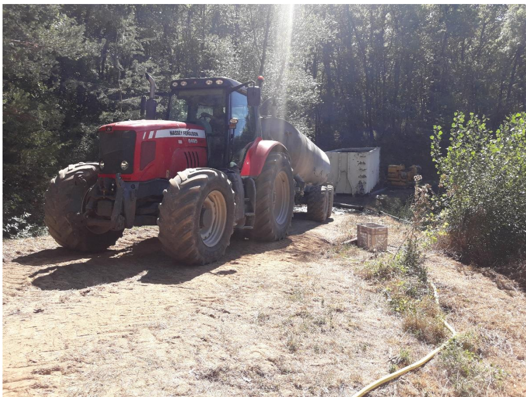
Figure 4 Photo AE: Pompage des boues depuis le caisson étanche par les tonnes à lisier
