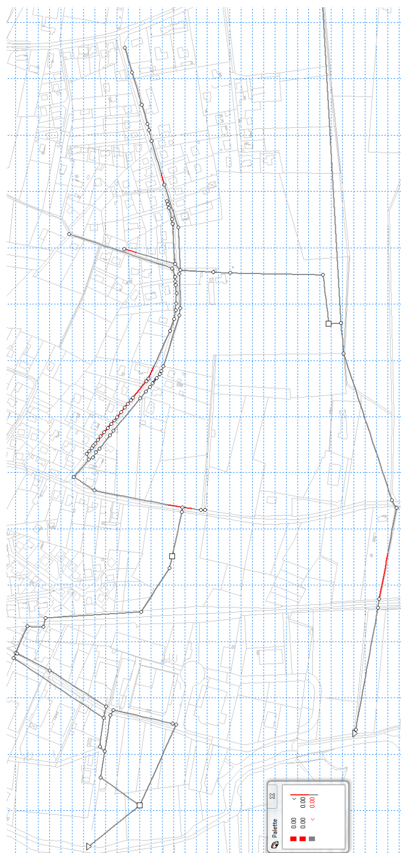
Figure n°16 : Localisation des débordements du réseau après travaux, T = 30 ans
