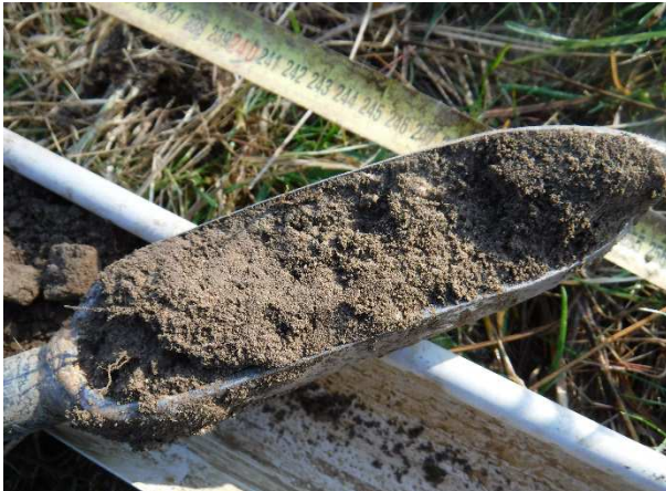
Photographie 2 - Horizon limoneux uniforme des premiers centimètres de profondeur (à gauche) ; taches d'oxydoréduction autour de 60 cm (sondage 1, à droite)
