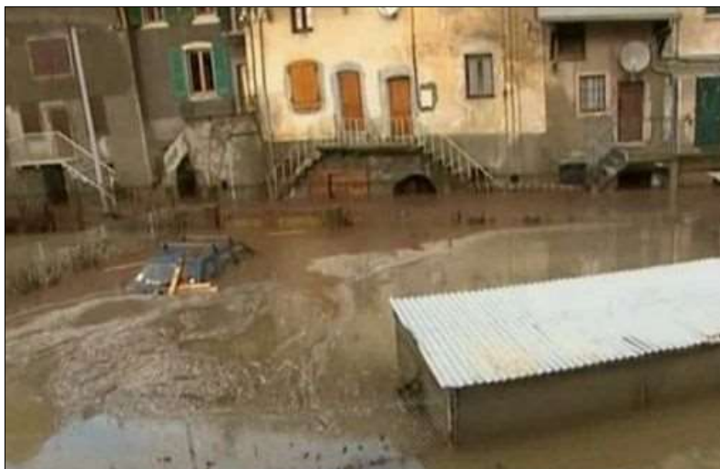
Figure 5: Crue de Combe de Lara le 25 décembre 2009. Après l'obstruction du tronçon souterrain, les eaux débordant en amont de la RN85 ont traversé les maisons avant de rejoindre le thalweg à l'aval du village
