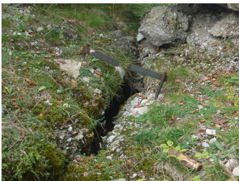
Figure 20: Fissuromètre sommaire surveillant une fissure ouverte
