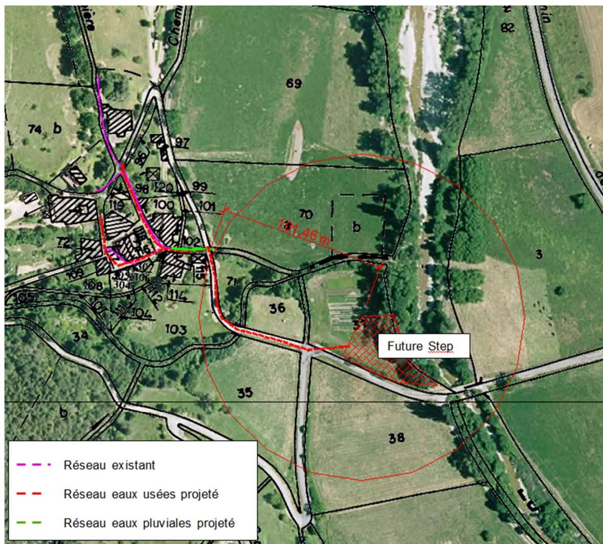
Extrait de plan 2 : Réseaux projetés - Hameau de Ribière - option station propre à Ribière
