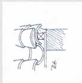
Ensemble de traitement des nœuds et des bas de pentes en technique traditionnelle.
