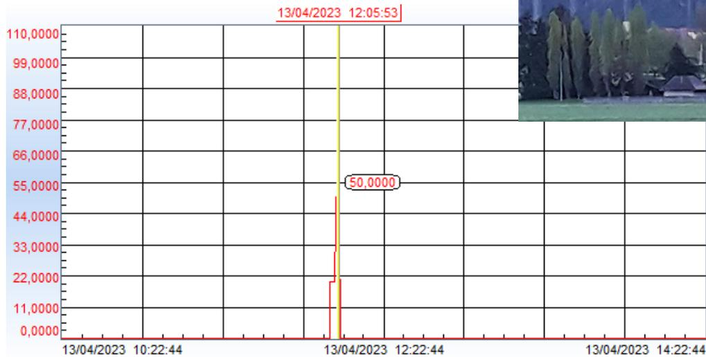
*Schéma montrant le pourcentage d'ouverture de la « Vanne 1 » indiquant un cycle de ramonage*
