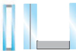
Figure 8 : Schéma d'un vitrage isolant double de type 4/16/4 (à gauche) et 44.2/12/4 (à droite)
