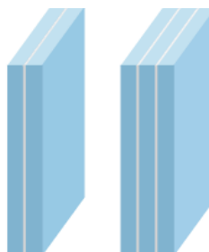
Figure 7 : Schéma d'un vitrage simple feuilleté de type 44.2 (à gauche) et 666.4 (à droite)
