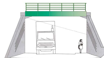
PONT - CADRE EN BÉTON
