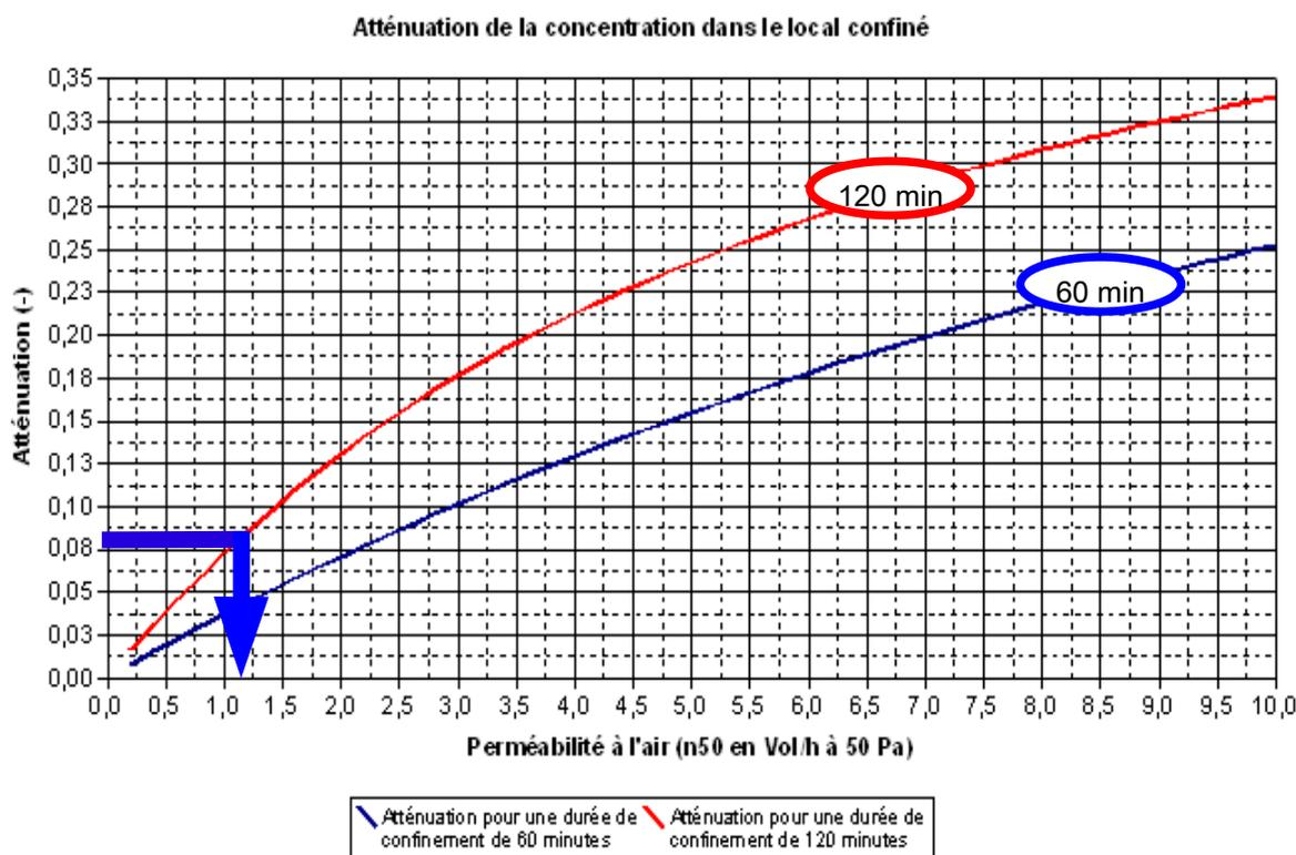
L'application à l'exemple étudié permet de conclure que : « pour les conditions atmosphériques, la typologie de bâtiment et la position du local correspondant à l'abaque choisi, le coefficient de perméabilité à l'air requis est de 1,15 vol/h sous 50Pa.
