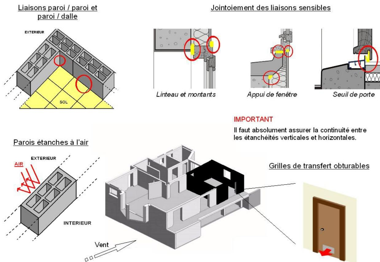
Figure 9 : Confinement structurel : exemple de travaux
