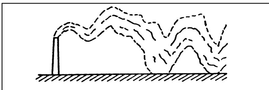
Figure 5 : Dispersion dans une atmosphère instable
