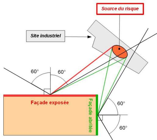
Dans des cas très particuliers, en présence de bâtiments longs, il est possible que la façade d'un local de confinement puisse être en situation d'exposition différente que celle de la façade du bâtiment sur laquelle il se situe (voir illustrations ci-dessous) :
