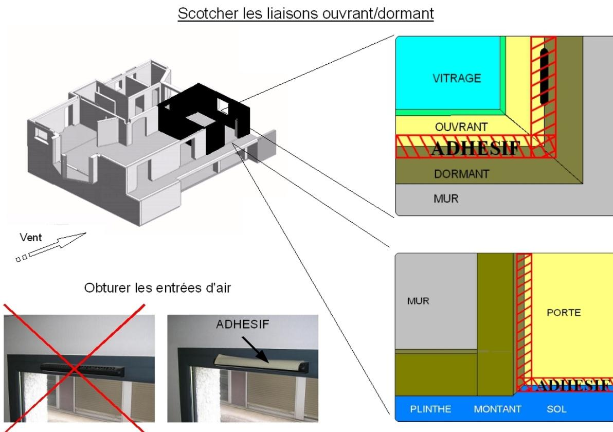
Figure 8 : Confinement non-structurel : exemples de mises en œuvre
