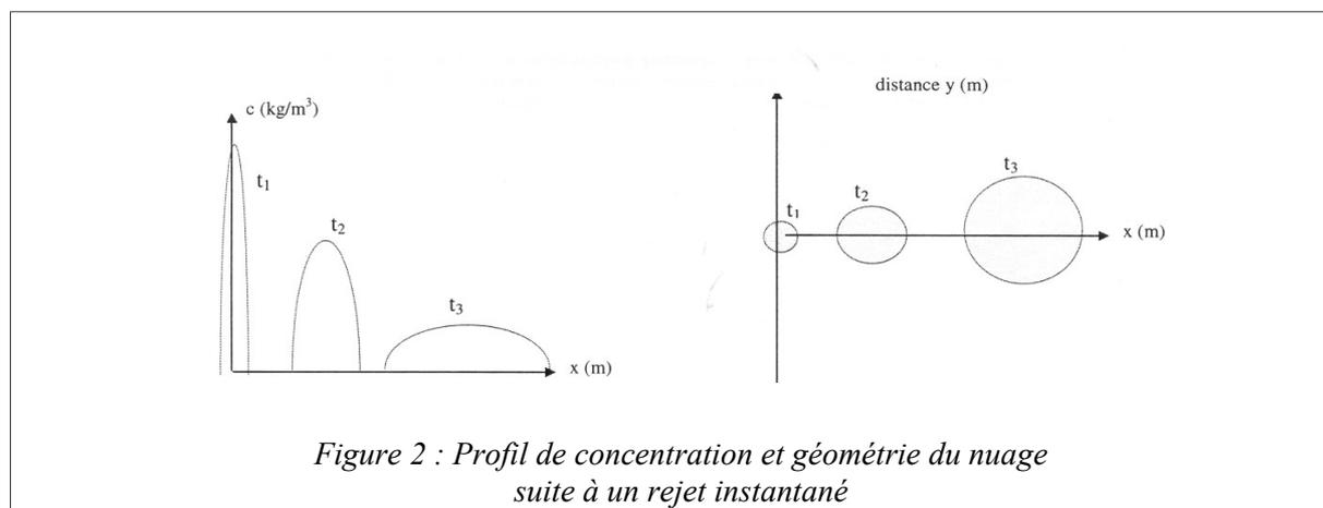
Figure 2 : Profil de concentration et géométrie du nuage suite à un rejet instantané
