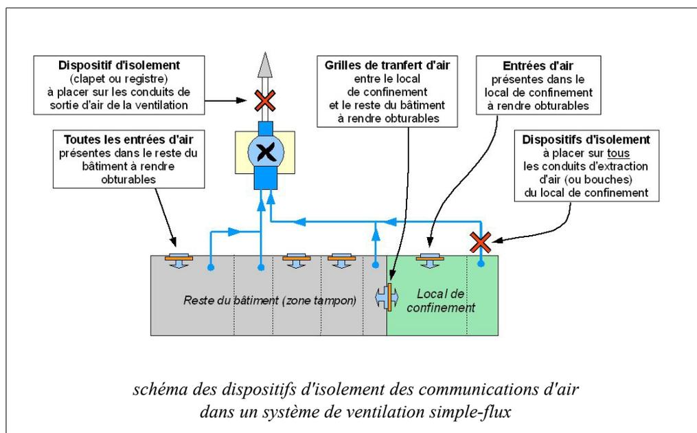
1. Toutes les grilles d'entrées d'air dans le bâtiment, et non seulement celles dans le local de confinement, devront être accessibles et obturables de manière à pouvoir les fermer rapidement. L'étanchéité à l'air des grilles situées dans le local de confinement, s'il en est pourvu, pourra être renforcée ensuite par un colmatage au moyen d'adhésif étanche.
