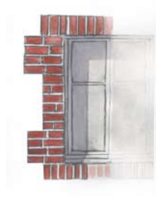
Encadrement de baie en brique
