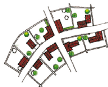
Tissu urbain aéré, bandes plantés et murs marquant l'alignement
