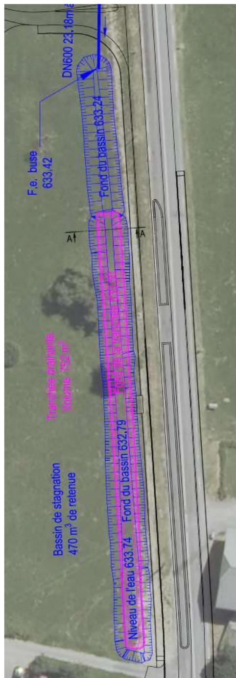
Figure 19 : Détail du bassin d'infiltration
