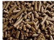
Les **granulés de bois** sont produits par compression et agglomération de sciure (pas d'agent de liaison). Ce sont de petits cylindres de 6 à 10 mm de diamètre et de 2 cm de long. Ils sont utilisés dans les **poêles** et les **chaudières à alimentation automatique de petite puissance**. Leur coût est plus élevé que celui des autres combustibles bois mais leur pouvoir calorifique est meilleur du fait de leur grande densité et de leur hygrométrie plus faible.
