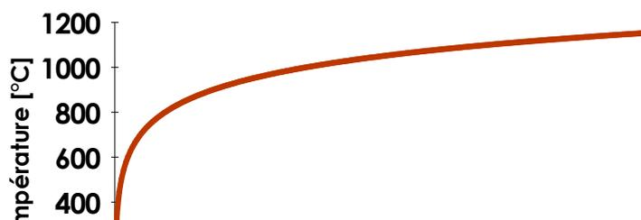
**Figure 3-2 : Courbe température-temps de l'incendie conventionnel (courbe ISO R834)**
