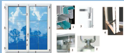
(1) Armature en acier, (2) Gâche métallique avec galet champignon, (3) Paumelle anti-dégondage (4) Exemple de système de fermeture individuelle de l'ouvrant
