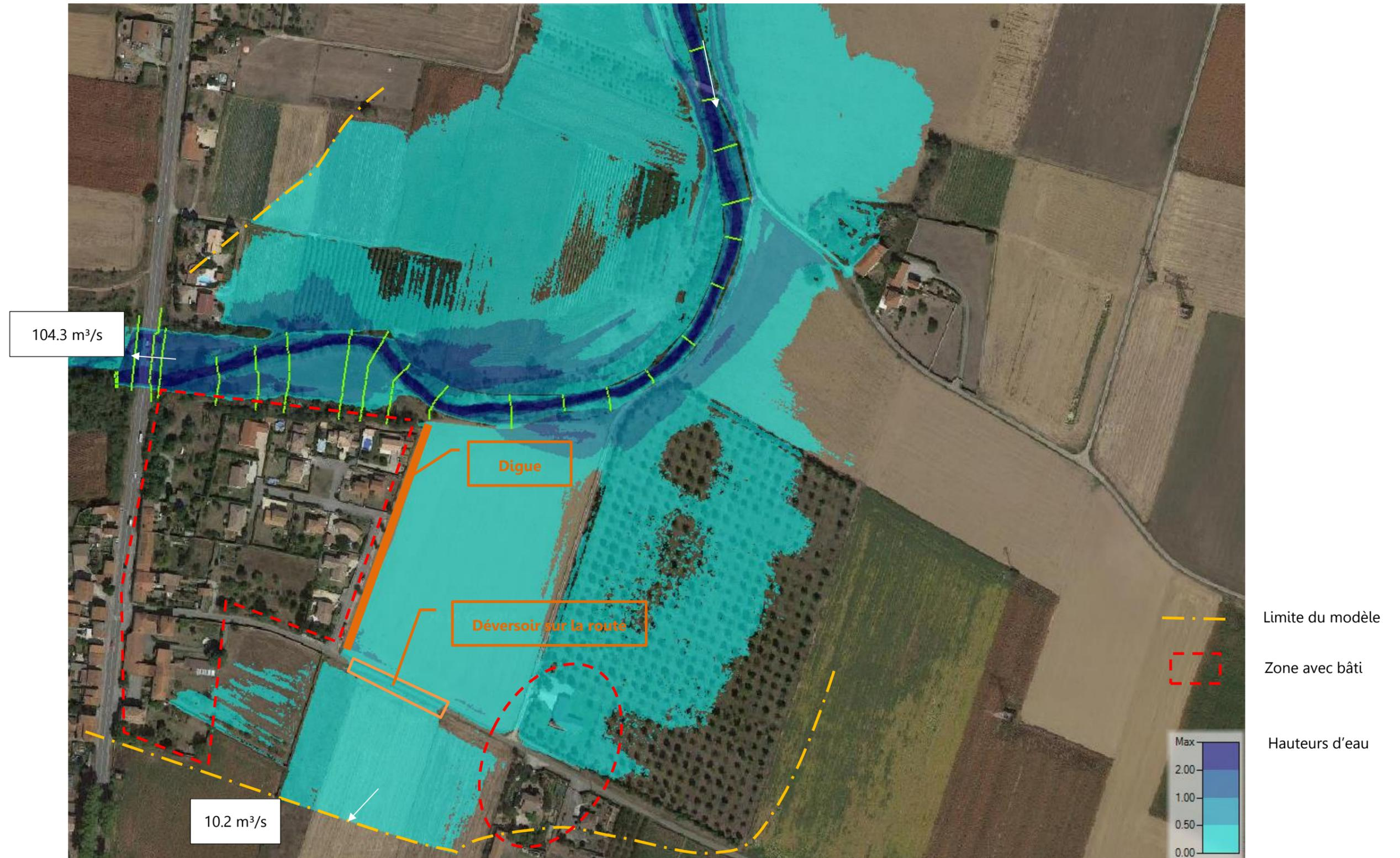
Figure 14 : Hauteurs d'eau issues de la modélisation Q100 à l'état projet avec réaménagement de la route du Bancel – HEC-RAS HYDRETUDES
